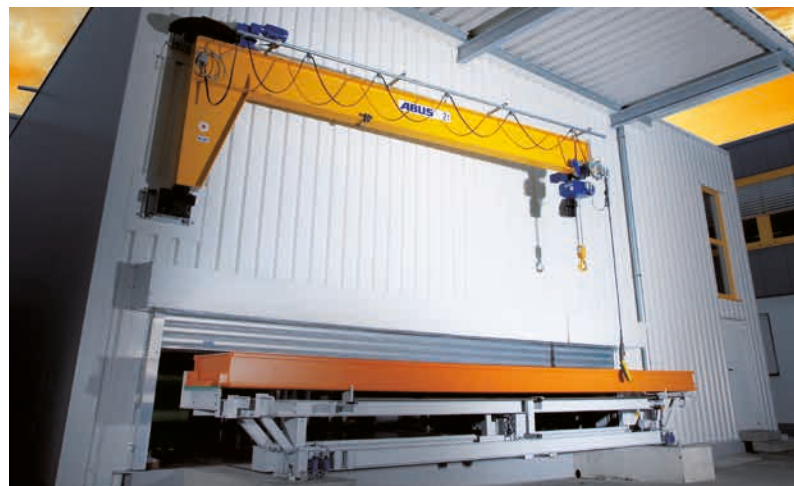
Querstation-Wagen, durch Hallenwand fahrend, mit Überdachung und Beladekran
