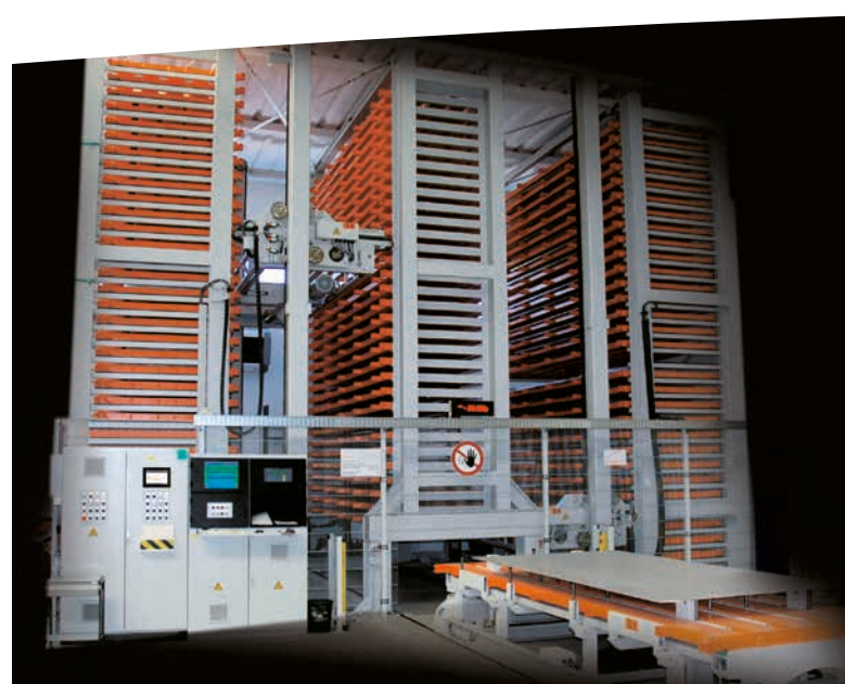
UNITOWER B, erweitert auf zwei Regalbediengeräte.
