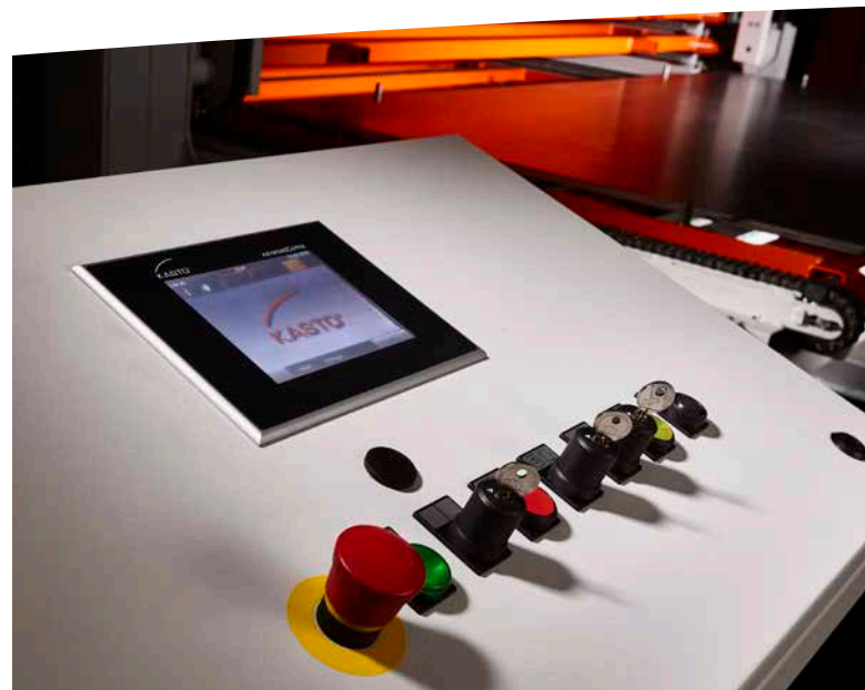
Lagersteuerung KASTO AdvancedControl mit Fachvorwahl und Zustimmungstaste
