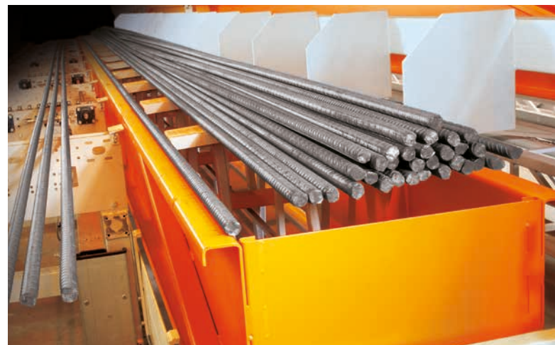
Querstation-Kettenförderer mit Aushub
