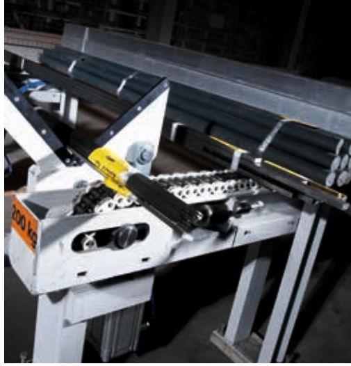
Dispositif manuel de mise en paquet avec convoyeur à paquets (revêtement PVC).
