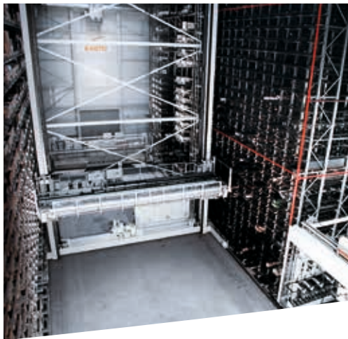
Centre logistique avec magasin en nid d'abeilles et cellule de sciage pour les produits longs, tôles et euro-palettes.
