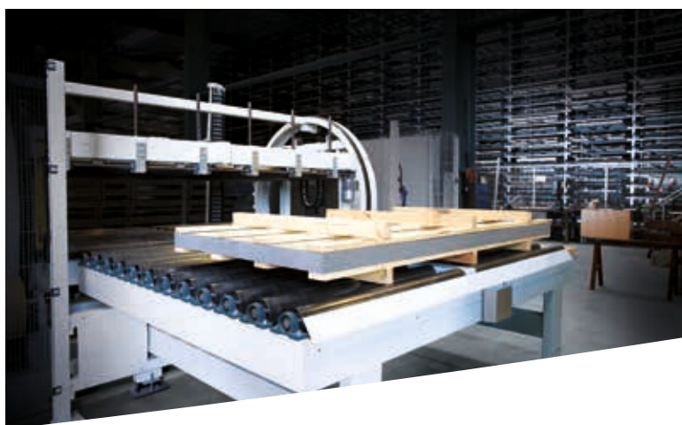
Machines à retourner les tôles pour le dépaquetage semi-automatique des paquets de tôles.
