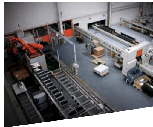
Magasin en nid d'abeilles avec machines à scier intégrées.
