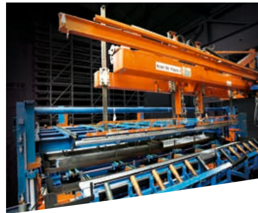
Dispositif de préparations de commandes avec traverse à pression à vide pour des produits longs non-magnétiques.
