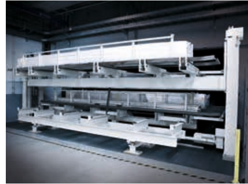
Station de circulation côté frontal du magasin avec capot de protection pour le changement cassettes pendant le prélèvement matières.
