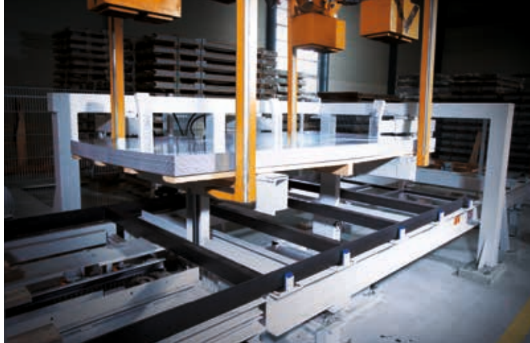
Chargement d'une palette pour tôles double profondeur au moyen d'un dispositif de relevage.
