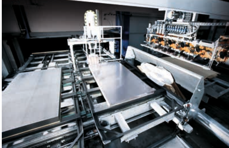
Station de circulation avec préparation de commandes des tôles entièrement automatique.
