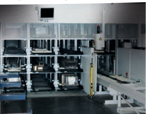
Zone d'accès manuel sur le côté longitudinal du magasin.
