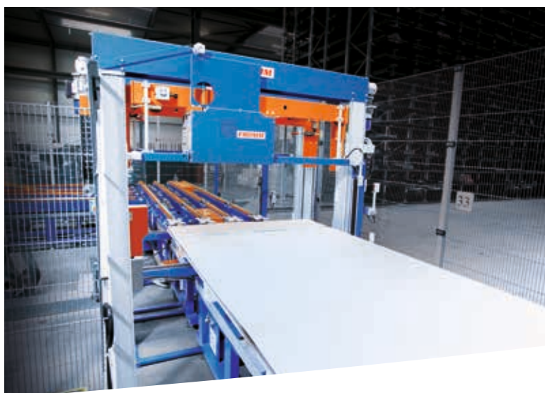
Dispositif de cerclage intégré tout automatique avec convoyeur.
