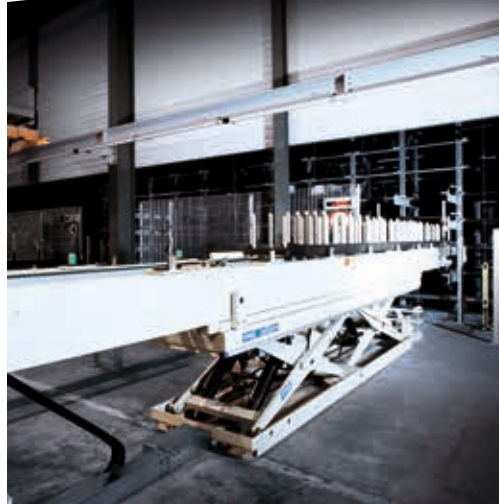
Station de levage pantographe côté longitudinal du magasin avec quatre emplacements logiques.
