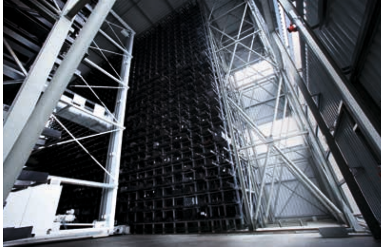
Bloc de rayonnage UNICOMPACT avec raccordement aux toit et murs.
