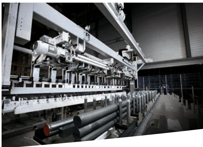
Manipulateur de barres individuelles KASTO lors de la séparation des barres par le dessus dans une cassette.
