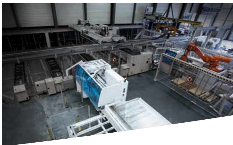
Cellule de sciage intégrée KASTOsawcell sur l'UNICOMPACT avec raccordement direct de deux scies KASTOvariospeed dans le négoce des aciers.
