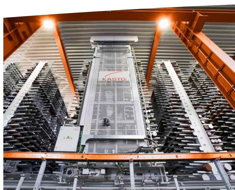
Transstockeur en version portique avec passerelle de maintenance
