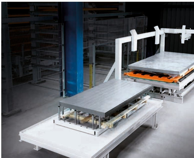
Station de préparation de commandes automatique avec système de transport de levage à dépression Table de déballage avec cadre mobile et station d'entrée et de sortie magasin.
