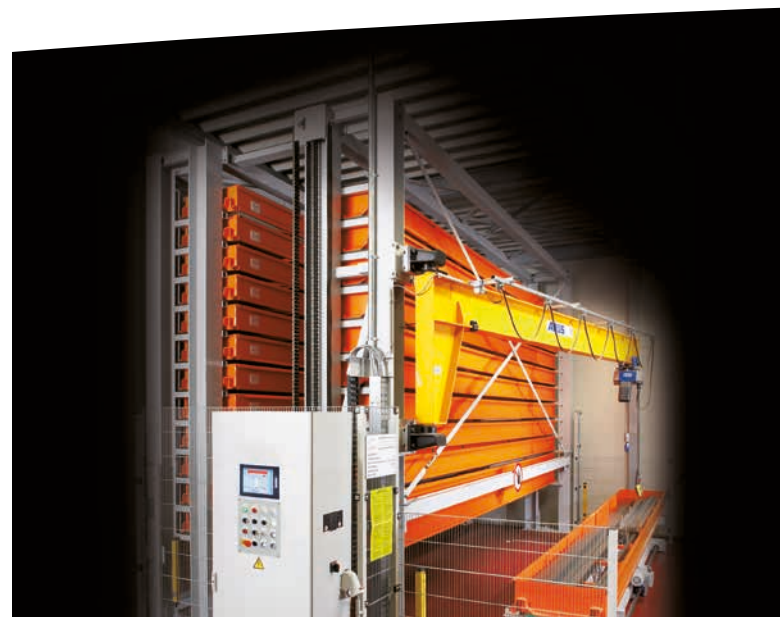
UNITOWER pour les produits longs, version double tour.
