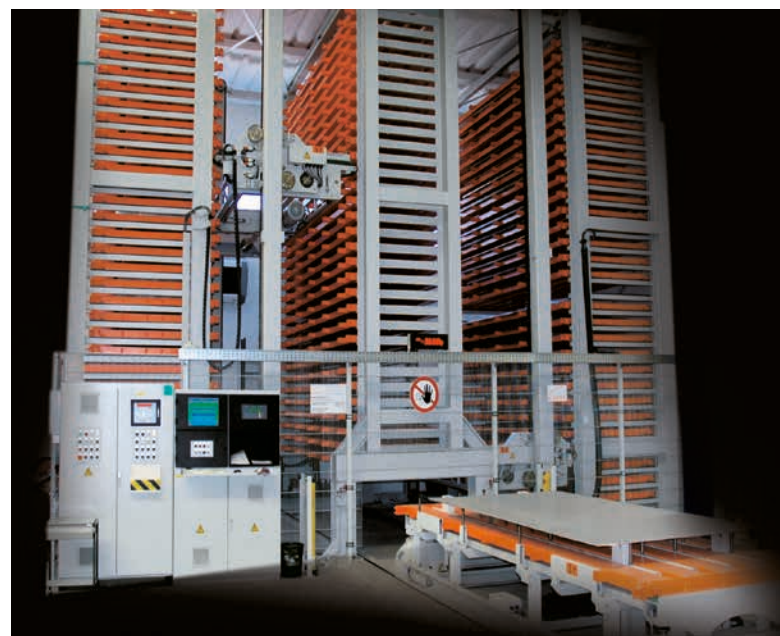
UNITOWER B étendu à deux transstockeurs.
