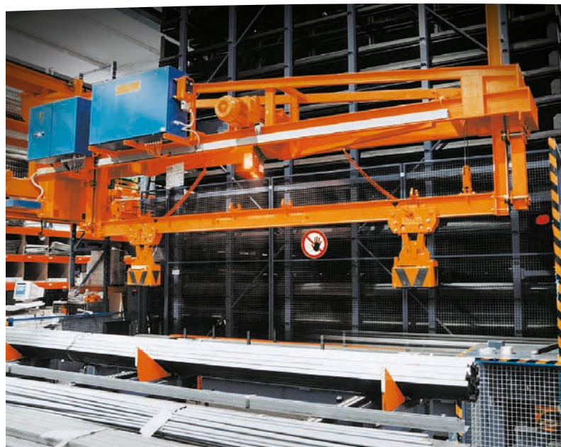
L'appareil de préparation de commandes permet un prélèvement ergonomique et rapide de la matière.
