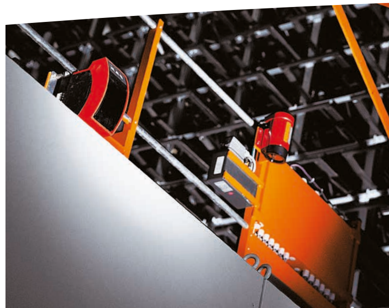
La barrière immatérielle et l'axe laser assurent une transmission précise des données et un positionnement précis du transstockeur
