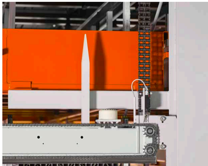
Station de stockage avec portique à butée pour matériaux et dispositif de levage intégré permettant un stockage facile grâce à un chariot élévateur.
