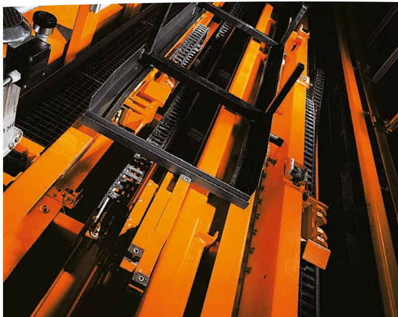
Transstockeur avec dispositif de traction pour le transport sécurisé des cassettes.
