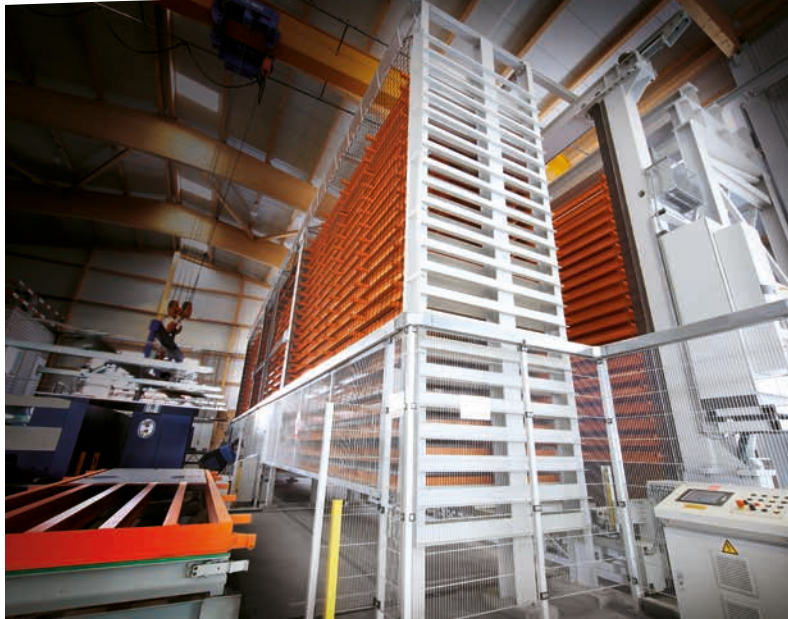
Stockage de paquets de tôles et station de sortie pour l'alimentation manuelle d'une machine de découpe laser. Station d'entrée et de sortie magasin sur trois étages.
